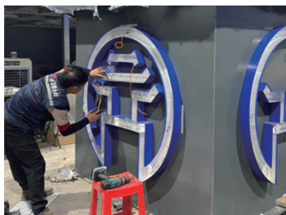
Gắn đèn LED và dây điện
